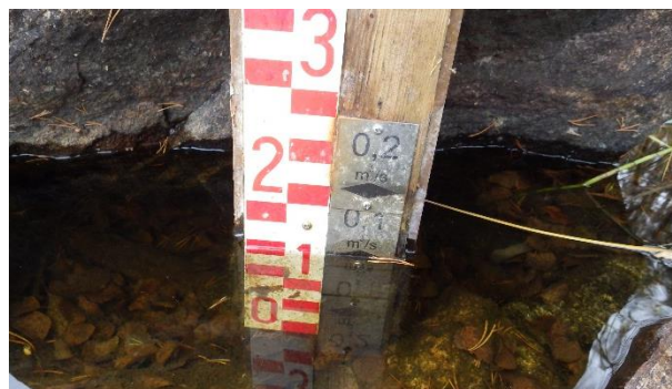
I den uppdämda ytan sitter vid den västra strandkanten en nivåpegel (se även v. bild h. kant) och anvisningar för minimivattenflöden. För tillfället var flödet som synes 0,1 m 3 /s.
